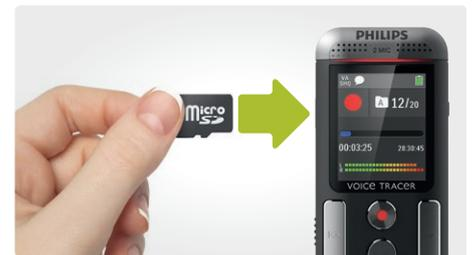
Praktisch unbegrenzte Aufnahme- und Speicherkapazität dank eines microSD-Kartensteckplatzes, der bis zu 32 GB zusätzlichen Speicherplatz unterstützt.
