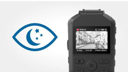
Die integrierte Nachtsichtfunktion nutzt 6 Infrarot-LEDs, sodass Sie auch nachts scharfe Videos erhalten. Aufnahmestart und -stopp werden durch LED-Anzeigen sowie (optional) akustisch und per Vibrationsalarm angezeigt.
