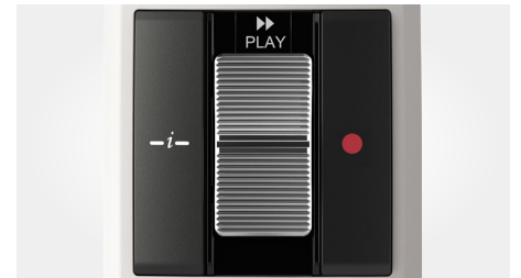
Posiciones del interruptor deslizante (avanzar, reproducir/grabar, detener, rebobinar)
