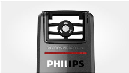
Das freischwebende Mikrofon ist vom Gerätegehäuse entkoppelt, was dafür sorgt, dass beinahe keine Geräusche durch Hintergrundaktivitäten, Berührung, Klicks, Luft oder Körperschall aufgenommen werden. Diese Technik, die von Studiomikrofonen stammt, verhindert Klangverzerrungen und ermöglicht Spracherkennungsergebnisse.
