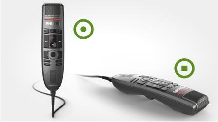
Das Philips SpeechMike Premium verfügt über einen integrierten Bewegungssensor. Es erkennt, wenn es auf den Tisch gelegt wird, und schaltet das Mikrofon stumm. Sobald Sie es wieder zur Hand nehmen, wird das Mikrofon wieder aktiviert. Zusätzlich können benutzerdefinierte Ereignisse programmiert werden, bei deren Eintreten das Gerät das Aufnehmen unterbricht und wieder fortsetzt.
