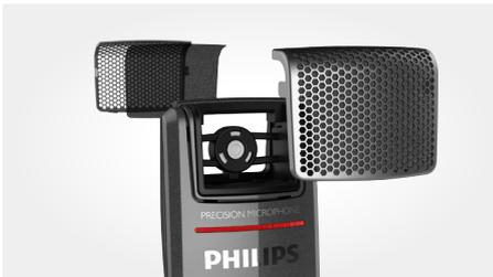
Die speziell entwickelten sechseckigen Öffnungen der Metallabdeckung bieten eine dreimal größere offene Oberfläche als beim Vorgängermodell und sorgen so für kristallklare Aufnahmen. Vliesstoff ober- und unterhalb der Mikrofonkapsel filtert Klangverzerrungen, wie Pop- oder Zischgeräusche, heraus und ermöglicht perfekte Aufnahmeergebnisse selbst beim Diktieren nah am Mikrofon.
